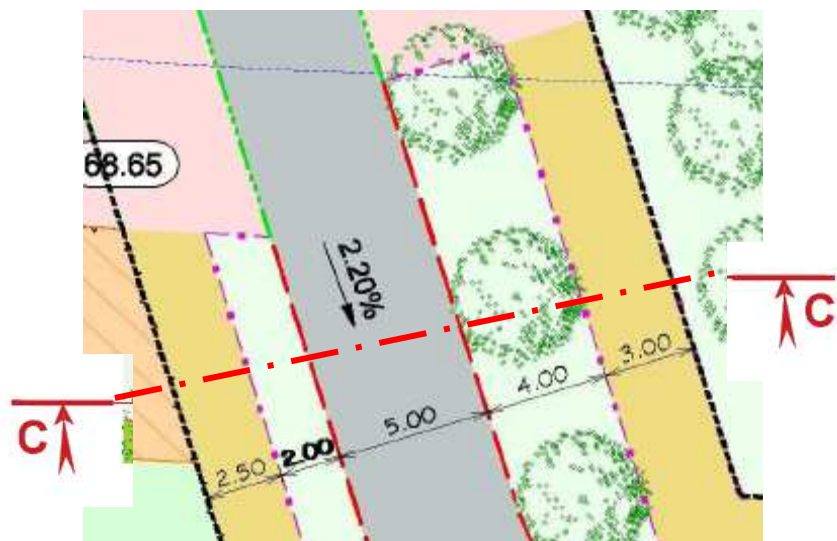
O. S-O. PROFIL TYPE DE LA VOIE EN DOUBLE SENS N°3 – COUPE CC :
